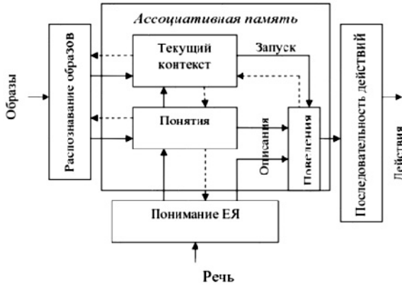
Рис. 2. Архитектура гибридной системы управления мобильным роботом
