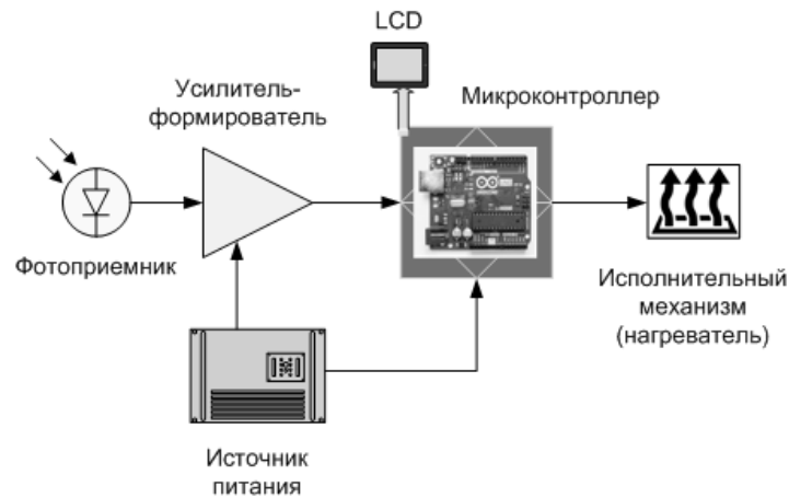
Рис. 2. Функциональная схема приемника
