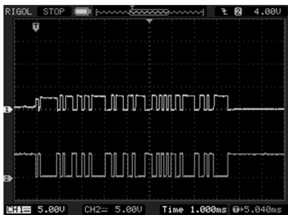
Рис. 11. Осциллограмма сигнала после второго каскада усиления приемника
