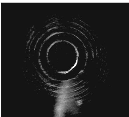
Рис. 3. Изображение интерференционной картины при фокусном расстоянии камерного объектива 50 мм
