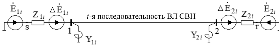
Рис. 3. Схема замещения i -й последовательности
