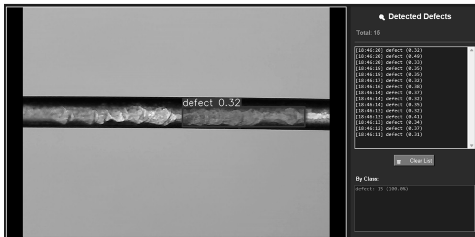
Рис. 4. Пример детекции дефекта на канатной проволоке диаметром 1,8 мм:
