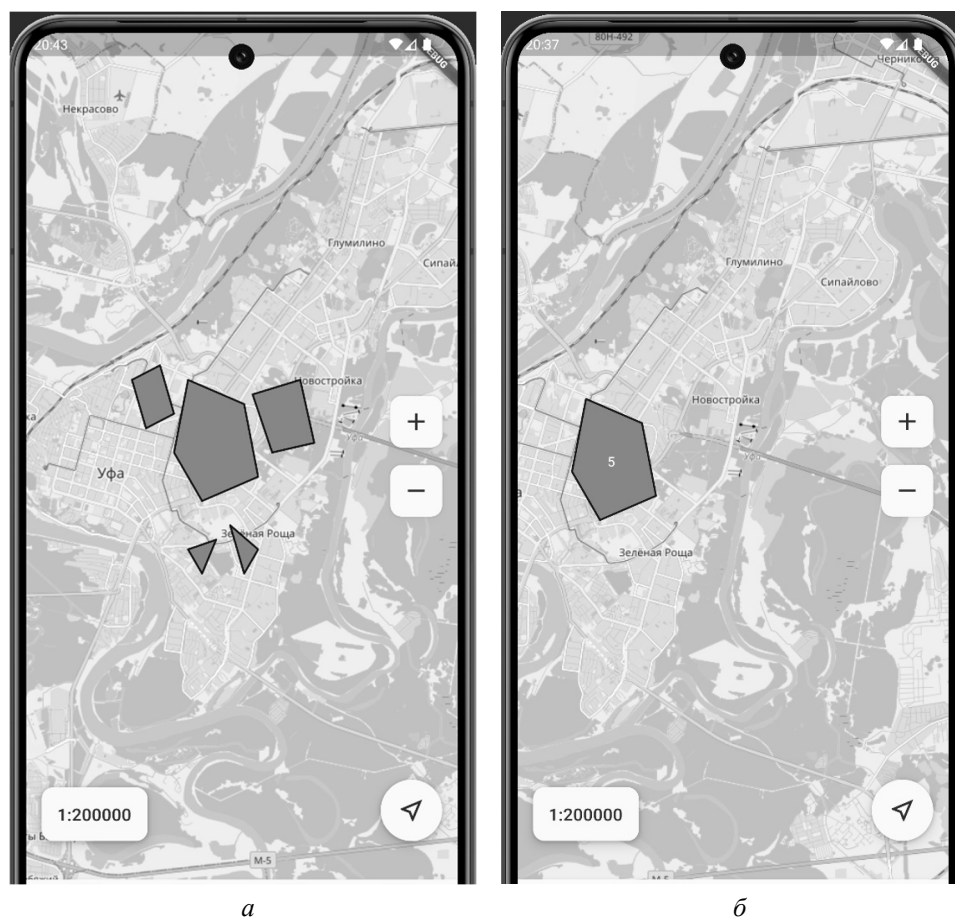
Рис. 2. Полигоны до применения кластеризации (а), после применения кластеризации (б)
