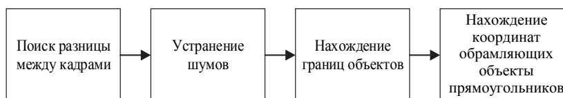
Рис. 1. Обобщенная блок-схема алгоритма программы нахождения движущихся объектов
