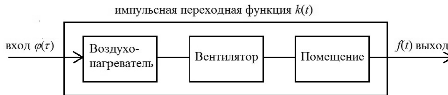
Рис. 1. Блок-схема системы регулирования микроклимата
