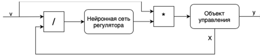
Рис. 3. Структурная схема замкнутой системы с нейронной сетью для обеспечения регулирования в любом значении диапазона
