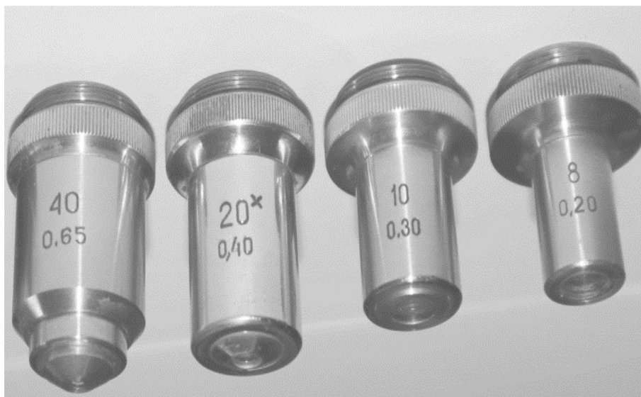
Рис. 1. Маркировка отечественных микрообъективов ЛОМО
