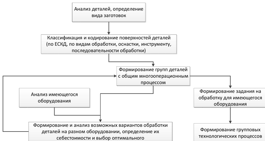
Рис. 1. Алгоритм проектирования группового технологического процесса
