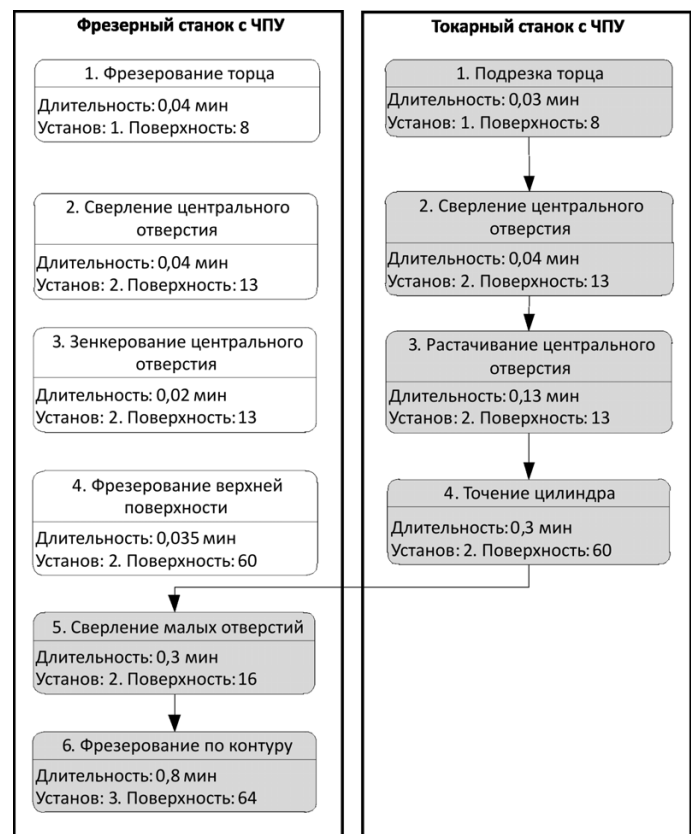
Рис. 5. Схема измененного технологического маршрута обработки детали 1
