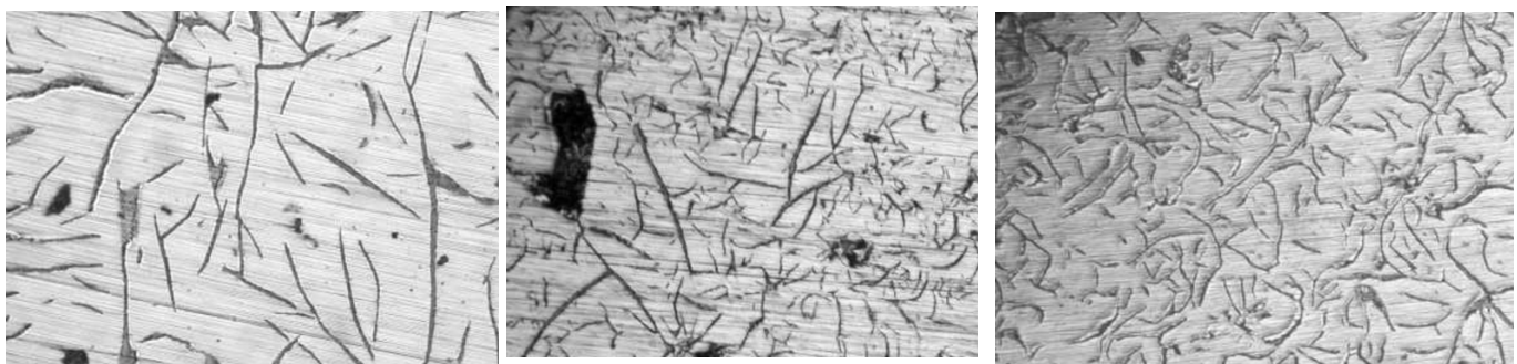
Рис. 1. Микроструктура образцов чугуна изложниц с различным временем продувки азотом:
