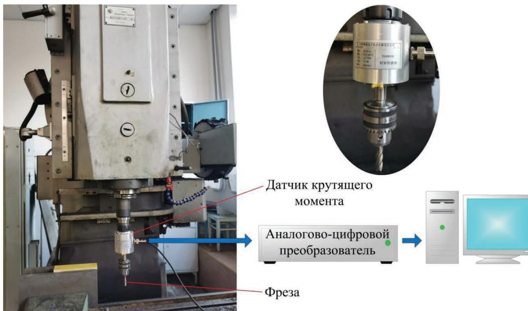
Рис. 1. Принципиальная схема экспериментальной установки
