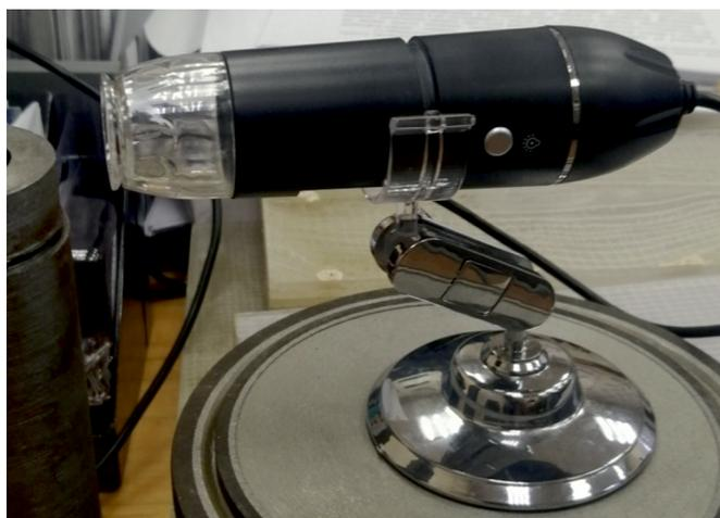
Рис. 2. Электронный USB-микроскоп
