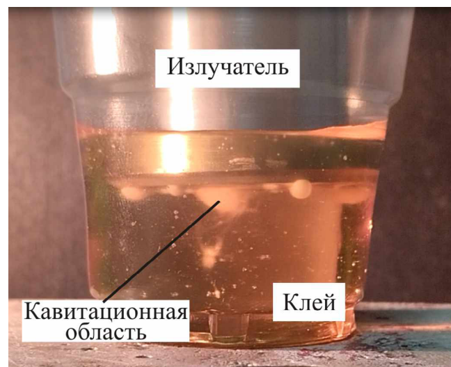
Рис. 2. Ультразвуковая обработка клея
