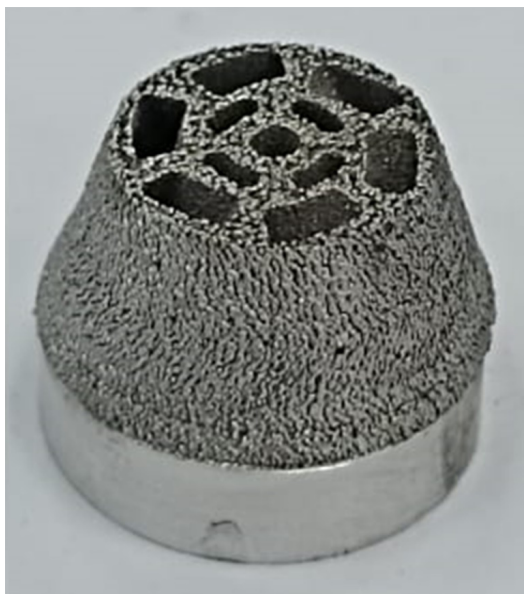
Рис. 11. Опытный образец завихрителя
