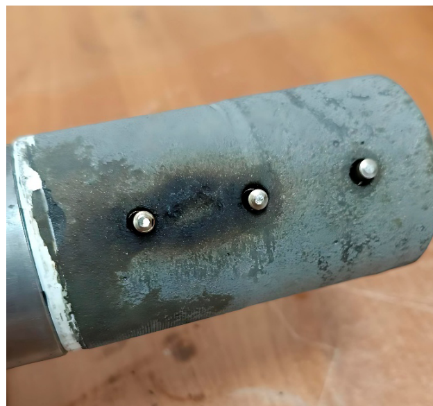
Рис. 2. Дефект (разрушение) металлополимера вследствие превышения допустимых для металлополимера температур
