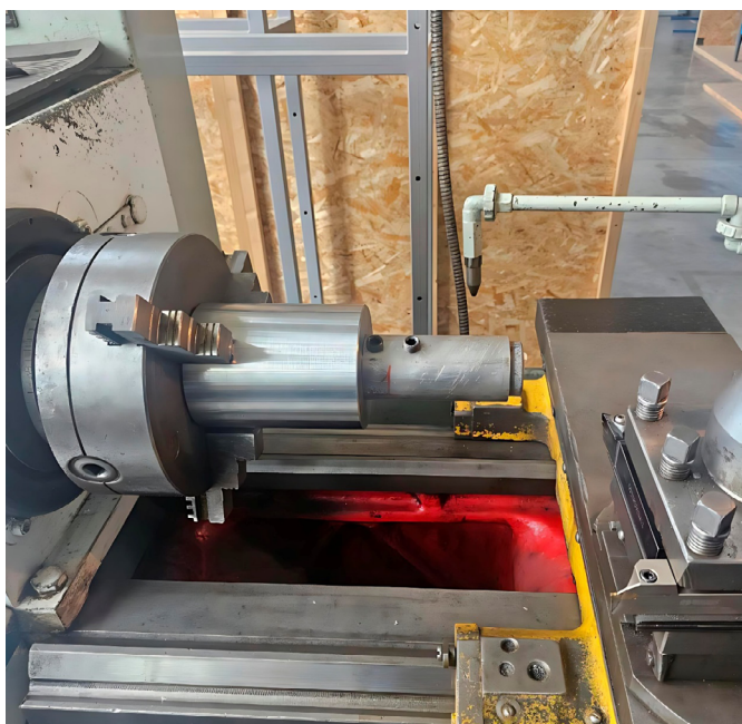
Рис. 1. Физическая модель эмулятора МКС для измерения температурных данных на границе фаз при точении, установленная в патроне станка 16K20
