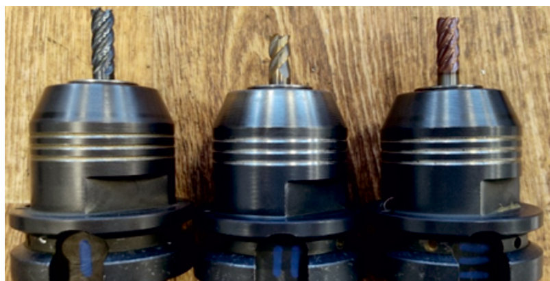
Рис. 3. Выбранный инструмент в гидропластовой оправке фирмы SCHUNK
