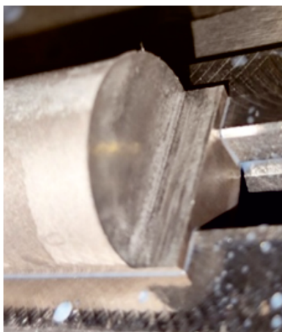
Рис. 5. Поверхность образца после JJ Tools 4SUE080120S08
