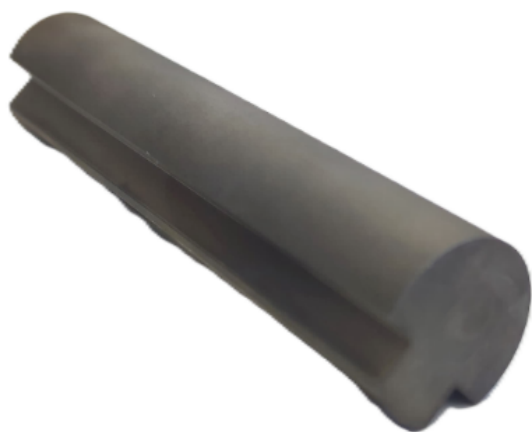
Рис. 2. Образец заготовки из сплава Mo30TiC с технологическим хвостовиком
