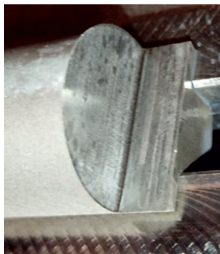
Рис. 6. Поверхность образца после CNCINS MS15.Z5.08.19.63.38.R05
