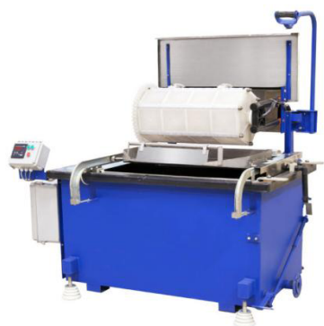
Рис. 1. Устройство подъема погружного барабана:
