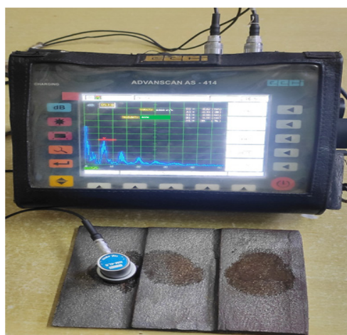
Рис. 1. Измерение скорости распространения ультразвуковых колебаний и сфероидизации ступенчатой отливки
