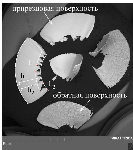
Рис. 14. Схема измерения параметров h_1 , h_2 , L_1 и L_2 , относящихся к расчёту коэффициента сплошности стружки
