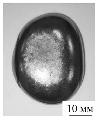
Рис. 2. Типичный вид слитков после выплавки
