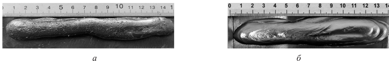
Рис. 5. Внешний вид валиков, наплавленных порошковой проволокой ( a ) и оболочкой без порошка ( б )
