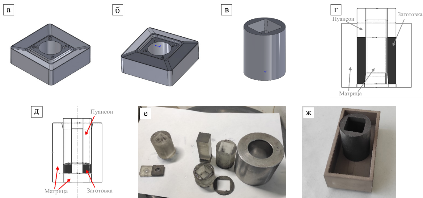
Рис. 2. Трехмерные модели заготовки режущей пластины (а), твердосплавного пуансона (б) и твердосплавной матрицы (в). Схемы прессования заготовок матрицы (г) и пуансона (д). Детали фотополимерной пресс-формы для изготовления твердосплавных заготовок пресс-формы (е), заготовка матрицы пресс-формы из сплава WC-15Co после прессования (ж)
