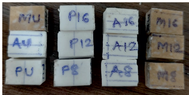
Рис. 1. Репрезентативные образцы ПТФЭ-нанокмпозитов для механических и трибологических испытаний после криогенной обработки
