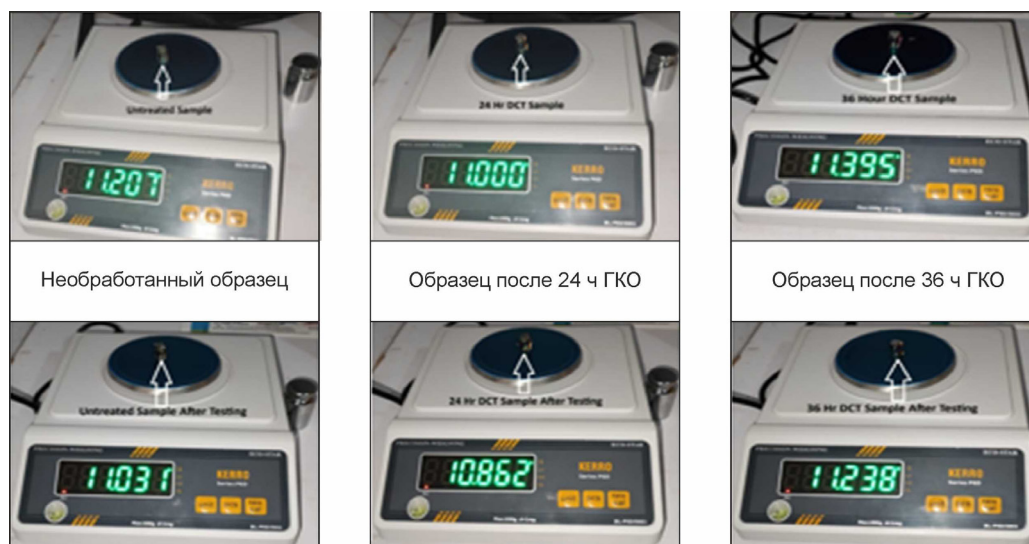
Рис. 8. Взвешивание образцов до и после испытаний на изнашивание
