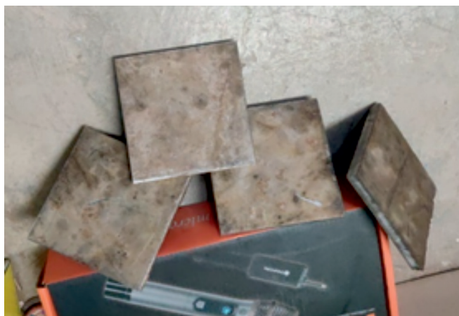
Рис. 1. Заготовки из технически чистого титана, использованные в исследовании
