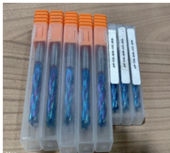
Рис. 2. Концевые фрезы из WC-Co, применявшиеся в исследовании
