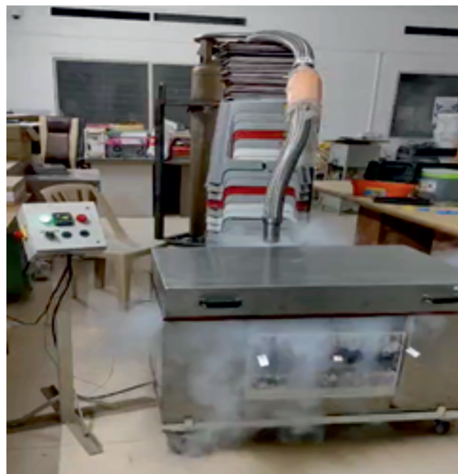
Рис. 3. Установка для глубокой криогенной обработки режущего инструмента из WC-Co
