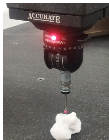
Рис. 7. Размеры таранной кости, измеренные на координатно-измерительной машине
