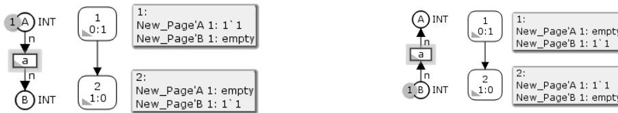
Рис. 1. Система, состоящая из двух мест: слева – сеть Петри и её дерево достижимости, справа – инвертированная сеть Петри и её дерево достижимости српн
