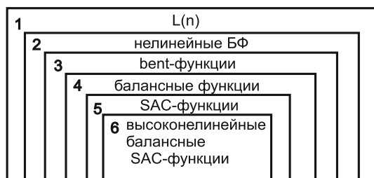
Рис. 1. Диаграмма Венна для криптографических булевых функций
