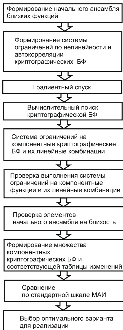
Рис. 2. Последовательность формирования криптографической функции в Cognate-форме представления
