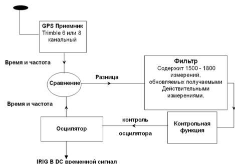
Рис. 3. Схема работы системы частотно-временной синхронизации XLI.
