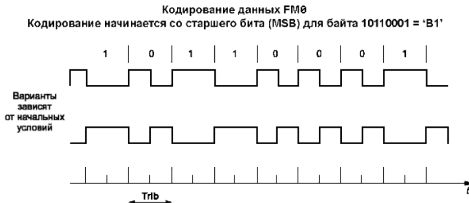
Рис. 1. Диаграмма, иллюстрирующая принцип модуляции физического уровня SBNI
