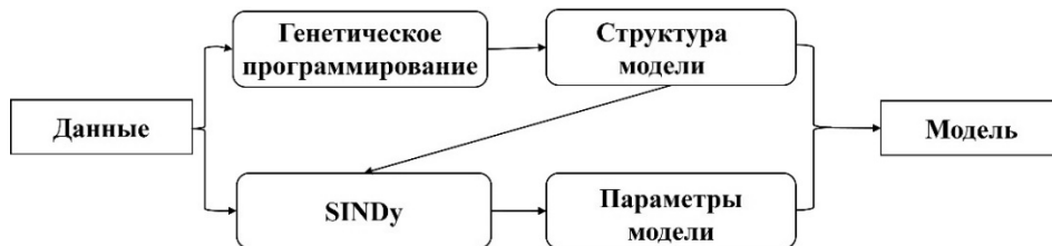
Рис. 3. Алгоритм гибридного метода GP – SINDy
