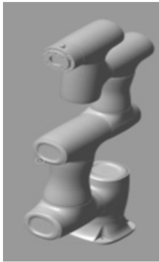
Рис. 5. URDF-модель робототехнического комплекса
