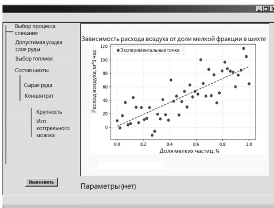
Рис. 4. Пример вывода зависимости расхода воздуха от доли мелкой фракции в шихте
