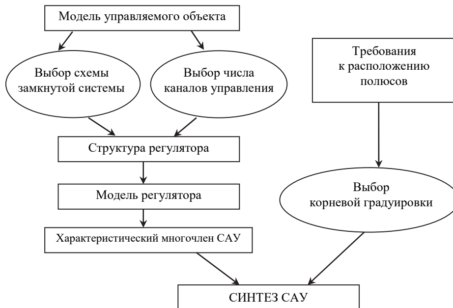
Рис. 1. Первая стадия метода критических корневых диаграмм: начальный выбор синтеза оптимальной САУ. Левая колонка связана с определением структуры САУ, правая – с формализацией требуемых системных свойств
