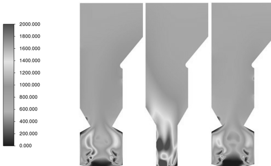
Рис. 2. Концентрации \text{NO}_x в продольных осевых сечениях полутопков и котла до введения низкоэмиссионных горелок, \text{мг}/\text{нм}^3
