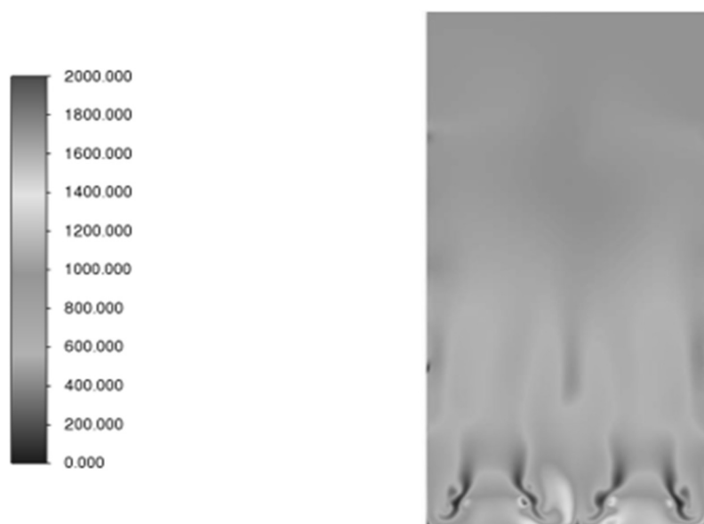
Рис. 5. Концентрация \text{NO}_x в поперечной оси топки после введения низкоэмиссионных горелок, \text{мг/нм}^3
